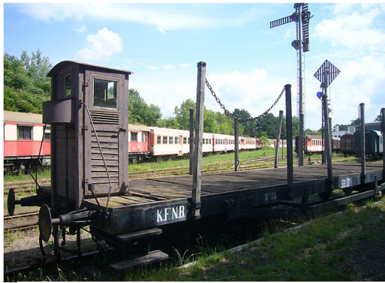
Langholz-Rungenwagen der Kaiser Ferdinand Nordbahn (Wien Nordbf—Brünn—Prag) von 1896. Im Hintergrund ausgemusterte Nahverkehrswagen der ÖBB, die momentan einen großen Fahrzeugpark-Erneuerungszyklus realisiert.
