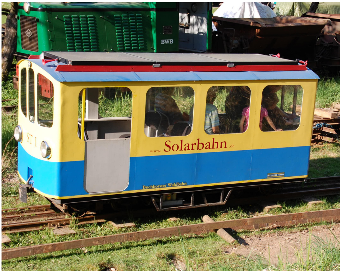
Der auf 2 zweischigen Drehgestellen aufgebaute Solartriebwagen der Buchhorster Waldbahn
